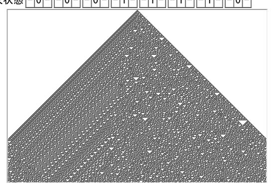
が 1 の状態から成長していく様子を表しています。<u>こちらのプログラム</u>で様々な規則番号での成長の様子を楽しんで下さい。規則90番(01011010)ではフラクタル図形である<u>シェルピンスキーのガスケット</u>が現れます。規則184番(10111000)は右方向へ進む車列を模しています。出現確率を変えて、渋滞(黒い線)が現れ逆方向に進む様子を観察してみましょう。<u>島根大学岩</u>本先生の解説も参考になります。
